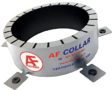
Collare antifuoco certificato secondo la norma EN 1366-3 per la sigillatura fino a EI 240 di attraversamenti di impianti meccanici ed elettrici a parete e soffitto. La struttura esterna in acciaio inossidabile permette una applicabilità anche in ambienti umidi mentre la striscia intumescente ad elevato potere espansivo permette di mettere in sicurezza anche elementi di elevata dimensione.
