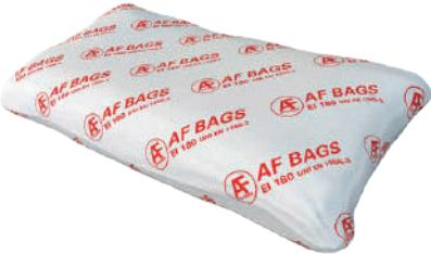
Sono cuscinetti antifuoco intumescenti ed ablativi certificati secondo la norma EN 1366-3 per la sigillatura fino a EI 240 di attraversamenti di passerelle portacavi, a parete e soffitto.
